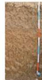
Limono-argileux en surface à plus argileux en profondeur, sain, brun à brun-gris en surface et rougeâtre en profondeur, différencié en 3 horizons, à faible charge en silex voire nulle, non calcaire mais saturé en calcium, teneur en matière organique moyenne à faible (1.5 à 2.5 %), issu de formations complexes de mélange.
