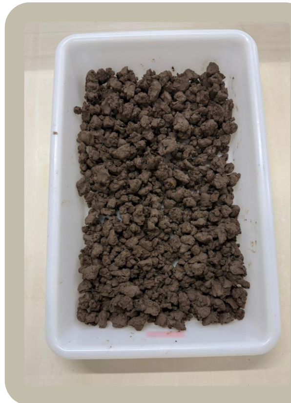
ETAPE 1 Réception & émottage
